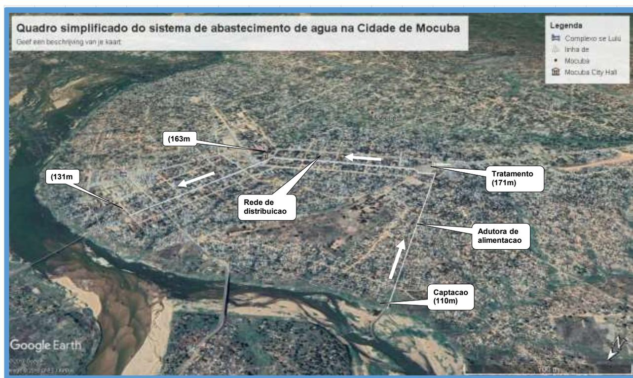
FIGURA 27 O ESQUEMA SIMPLIFICADO DO SISTEMA ACTUAL DE ABASTECIMENTO DE ÁGUA DE MOCUBA
